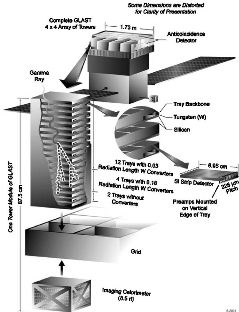
Fig. 1. The GLAST-LAT detector.
