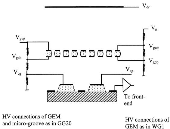
Fig. 1. Micro-groove-GEM layout.
